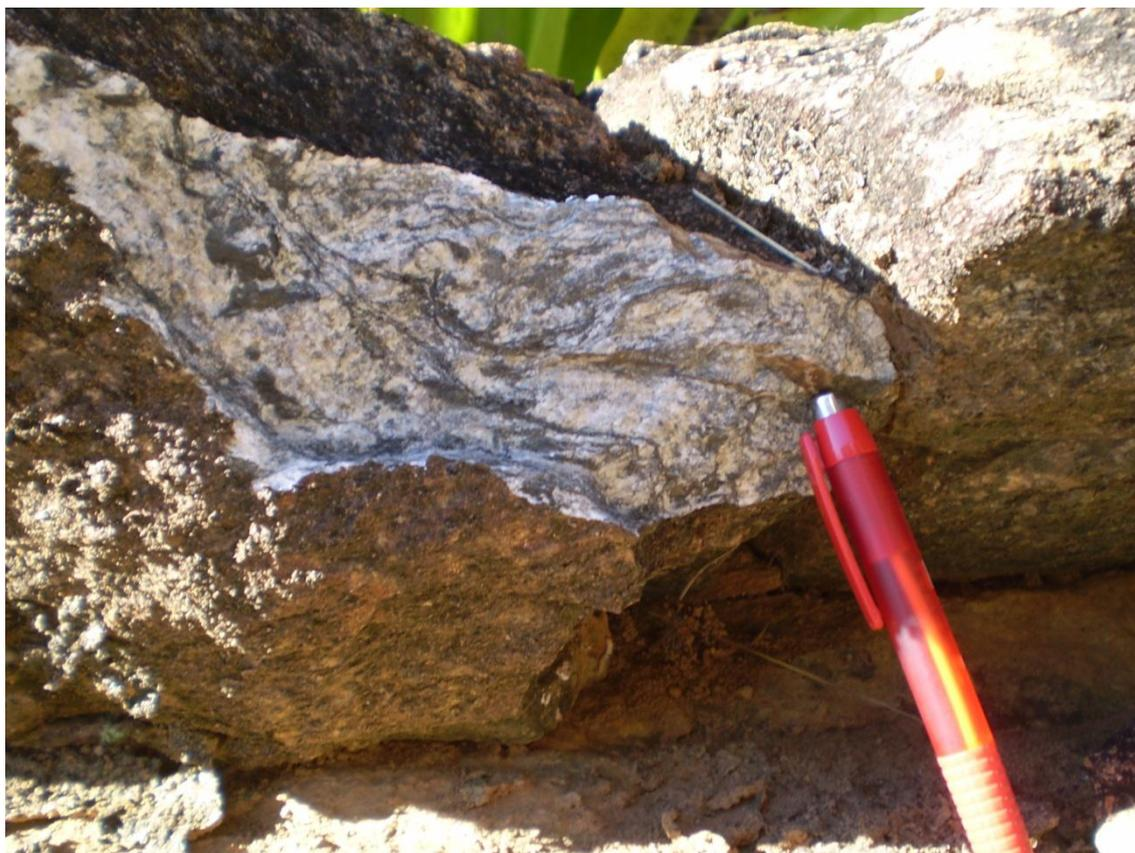
**FIGURA 6.40. Gnaisse cinza médio, com nítido bandamento composicional, inalterados e muito resistentes.**
