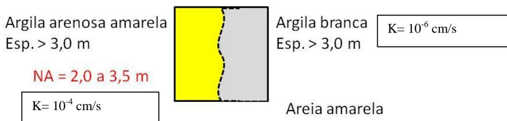
**FIGURA 6.46. Perfil típico de alteração do dique 05 (furos 1A-5 e 1B-5), com seus respectivos coeficientes de condutividade (K).**
