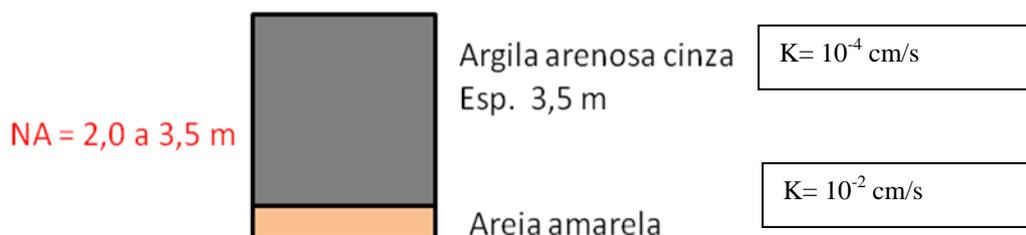
**FIGURA 6.45. Perfil típico de alteração do dique 04 (furos 1A-4 e 2B-4), com seus respectivos coeficientes de condutividade (K).**
