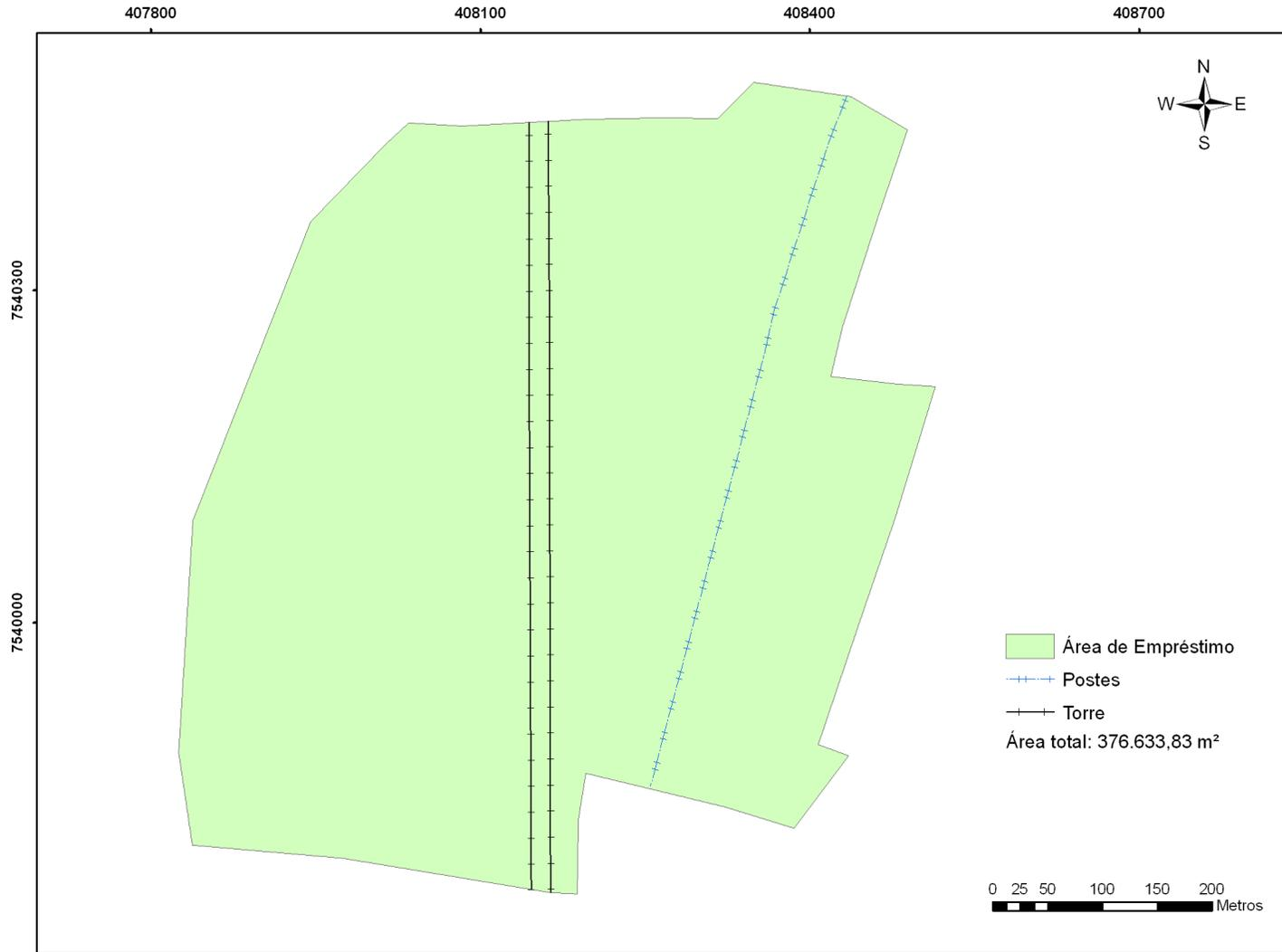
**FIGURA 6.78.** Representação da Área de Empréstimo 02, contendo linhas e torres de transmissão de energia elétrica.
