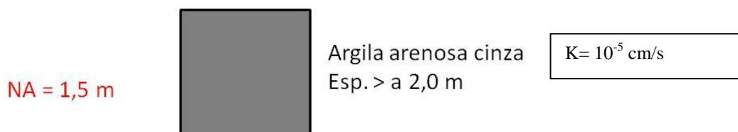
**FIGURA 6.43. Perfil típico de alteração do dique 02 (furos 1B-2, 2B-2, 3B-2, 4B-2 e 2A-2), com seu respectivo coeficiente de condutividade (K).**
