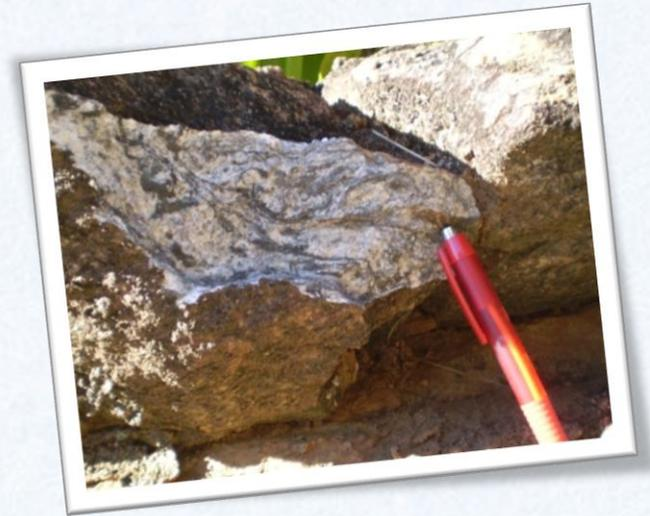
**Figura 5.9:** Gnaisse cinza médio, com nítido bandamento composicional, inalterados e muito resistentes
